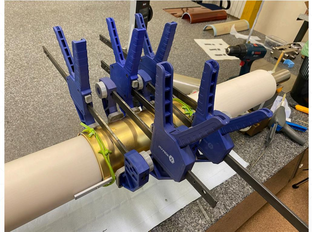
Процедура нанесения эпоксидной смолы и склейка катода и силового каркаса
