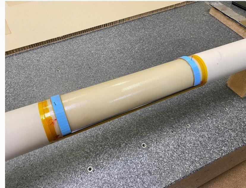
Материал: FR4 (толщина = 300 микрон). Силовой каркас: пластиковые дуги, графитовые стержни
