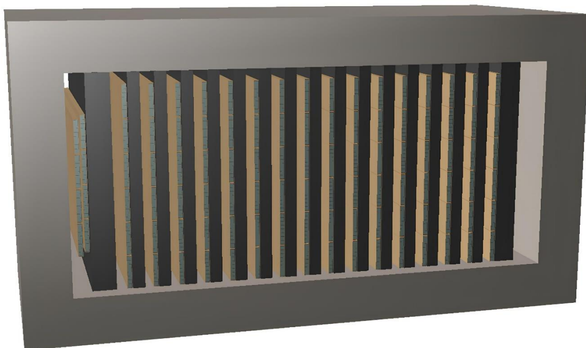
Рисунок 4 – Геометрическая модель прототипа мюонной системы SPD
