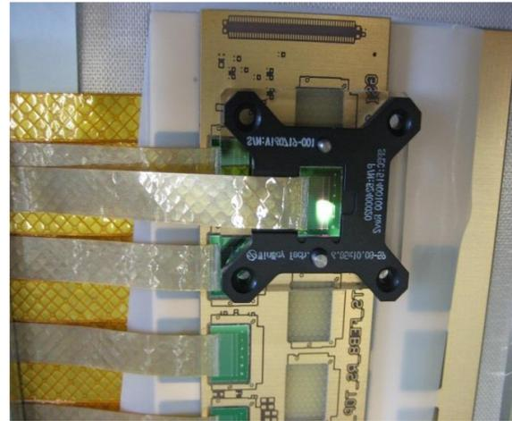
Test socket for the ASIC-tab-bonds
