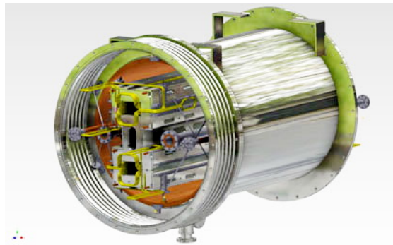
Рис. 1: Сверхпроводящий двухапертурный дипольный магнит коллайдера (без кожуха) с рабочим магнитным полем до 1.8 Т [8]. Направления вертикального магнитного поля в апертурах противоположны.
